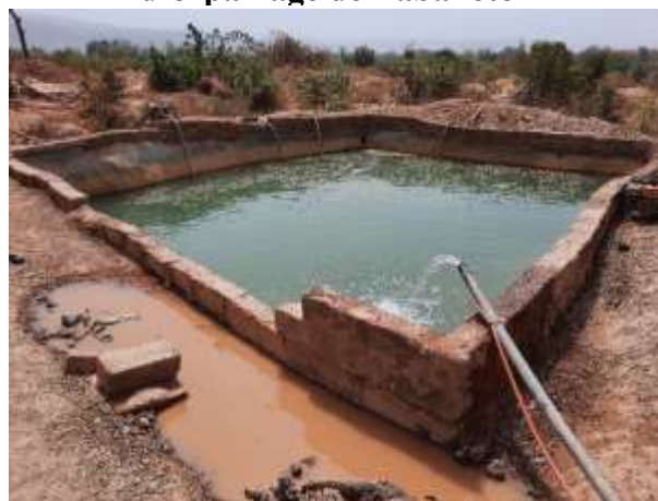
Photo 6 : Bassin de stockage d'eau pour le traitement des minerais sur un site d'orpaillage de Tabakoto
