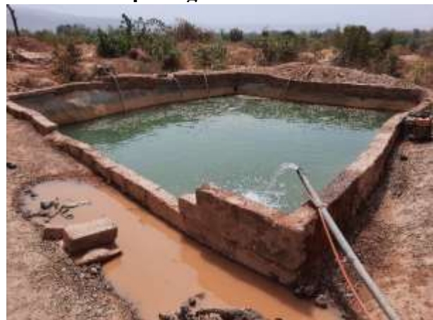
Photo 6 : Bassin de stockage d'eau pour le traitement des minerais sur un site d'orpaillage de Tabakoto
